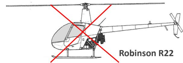
La résonance sol est un **mouvement oscillatoire divergent dû à la mise en résonance de la cellule de l'hélicoptère avec le sol sous l'excitation des vibrations des pales en traînée**. Les différents systèmes d'amortissements permettent d'éviter ce phénomène.
