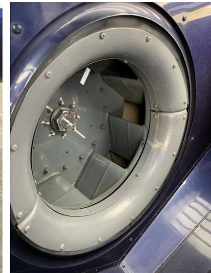
Des conduits fournissent l'air de refroidissement à l'alternateur, à au réservoir hydraulique, à la boîte de transmission principale et aux têtes de cylindres.
