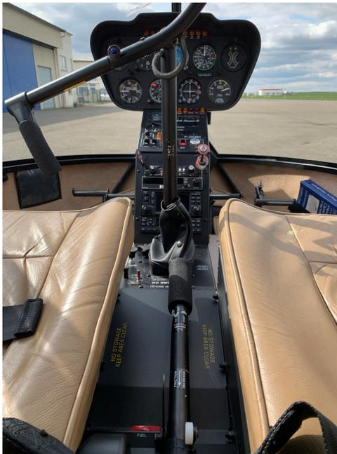
La commande de pas collectif, elle aussi est conventionnelle et comprend la classique poignée tournante de commande moteur. Quand le collectif est levé, le débitmètre est ouvert automatiquement, grâce à des bielles de conjugaison gaz/pas.
