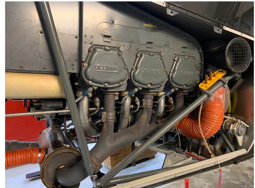
Il est équipé d'un injecteur (Raven II) ou carburateur (Raven I), d'un démarreur, d'un alternateur, d'un allumage antiparasité, de deux magnétos
