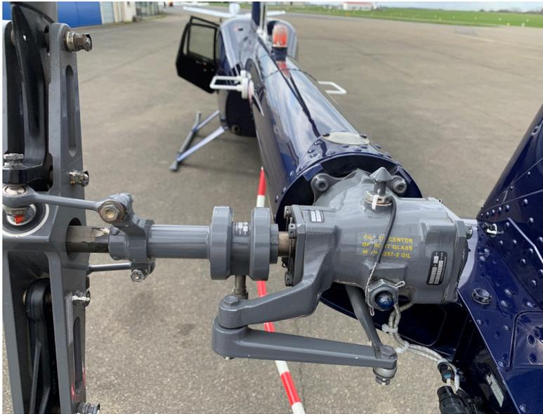
L'arbre long de transmission du rotor de queue, ne possède pas de palier mais possède un roulement amortisseur. La boîte de transmission arrière contient un couple spiro-conique lubrifié par barbotage. Les arbres d'entrée et de sortie de la boîte de transmission arrière sont tous deux en acier inoxydable.
