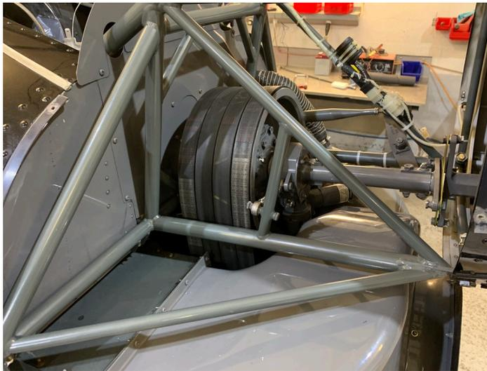
L'arbre interne de la roue libre transmet le mouvement, vers l'avant à la boîte de transmission principale, et vers l'arrière, au rotor de queue.
