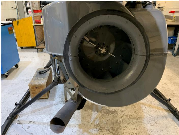
Un ventilateur de refroidissement type « cage à écureuil », entraîné directement par le vilebrequin moteur fournit l'air de refroidissement nécessaire au cylindres et au radiateurs d'huile par l'intermédiaire d'une enveloppe faite de métal léger et de fibre de verre.
