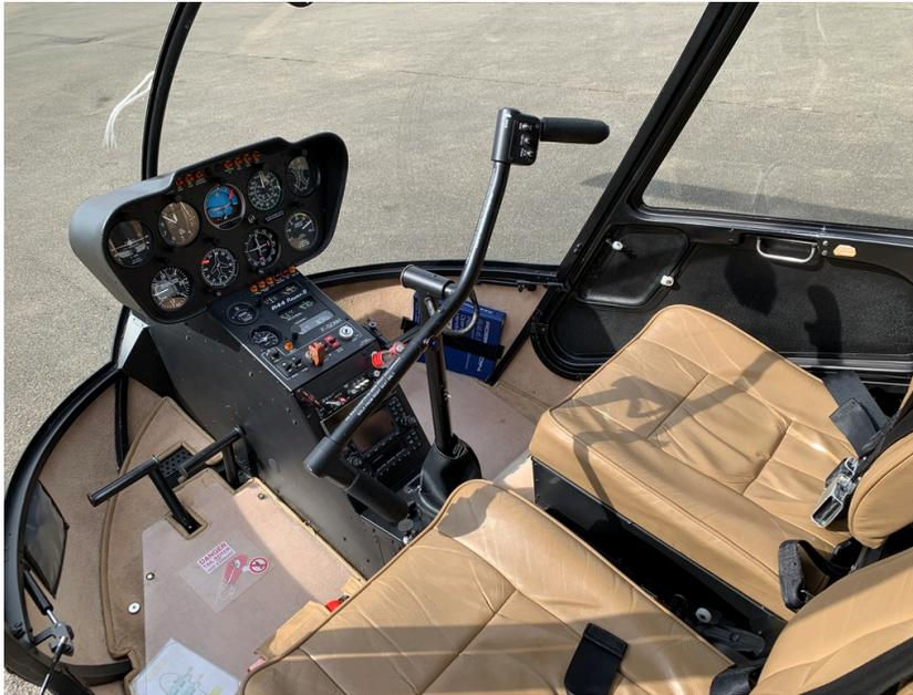
Les doubles commandes constituent l'équipement standard et toutes les commandes primaires sont actionnées par des tubes à doubles actions et biellettes. Les roulements et rotules utilisés dans l'ensemble des commandes de vol sont, soit des roulements à billes étanches, soit des biellettes à embouts Téflon auto-lubrifié.
