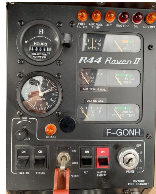
Le circuit électrique comprend un alternateur 24 volts ou, 60 Ampères, un régulateur de tension, un relais batterie et une batterie de 24 volts (Raven II) ou 28 volts (Raven I).
