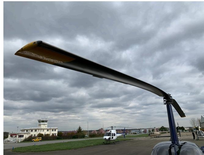
Deux pales métalliques, bord d'attaque en acier inoxydable, la structure intérieure étant en nid d'abeille.
