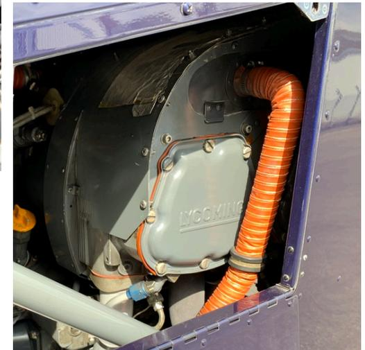
L'air d'admission moteur est admis par l'ouverture située sur la partie droite de l'hélicoptère, et se trouve guidé vers le débitmètre par une conduite flexible.
